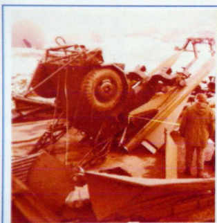
Im Rahmen der Fehlersuche kippte bei der 4. Batterie infolge unsachgemäßer Bedienung ein Launcher mit drei aufgelegten HAWK-Flugkörpern um, wobei neben dem Launcher auch die drei Raketen stark beschädigt wurden
